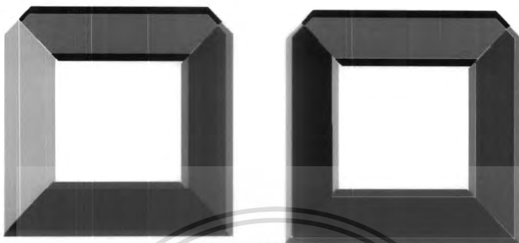
รูปที่ 5.8 การเรียงแกนเหล็ก หน้าตัด 80 mm
