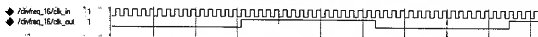
รูปที่ 4.11 แสดงผลจำลองการทำงานของวงจร DIV_FREQ
