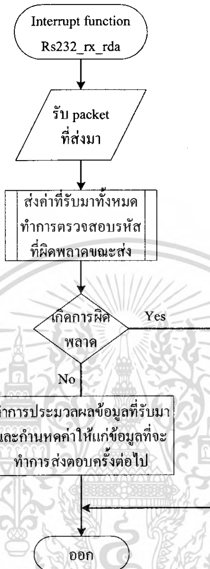
รูปที่ 3.8 แสดง flow chart ของ interrupt function Rs232_rx_rda ของ Tag และ Reader
