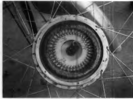
รูปที่ 5-4 ลักษณะภายในมอเตอร์แบบคุมด้านตรงข้ามสายไฟเข้า
