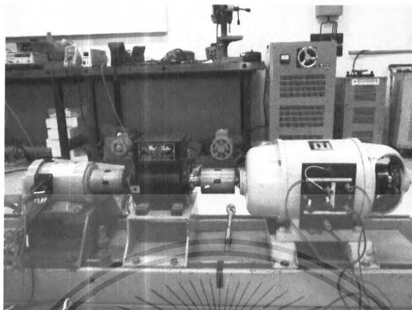
รูปที่ ๕.๕ ชุดทดสอบเครื่องกำเนิดไฟฟ้าเหนี่ยวนำต่อเข้ากับโครงข่าย
