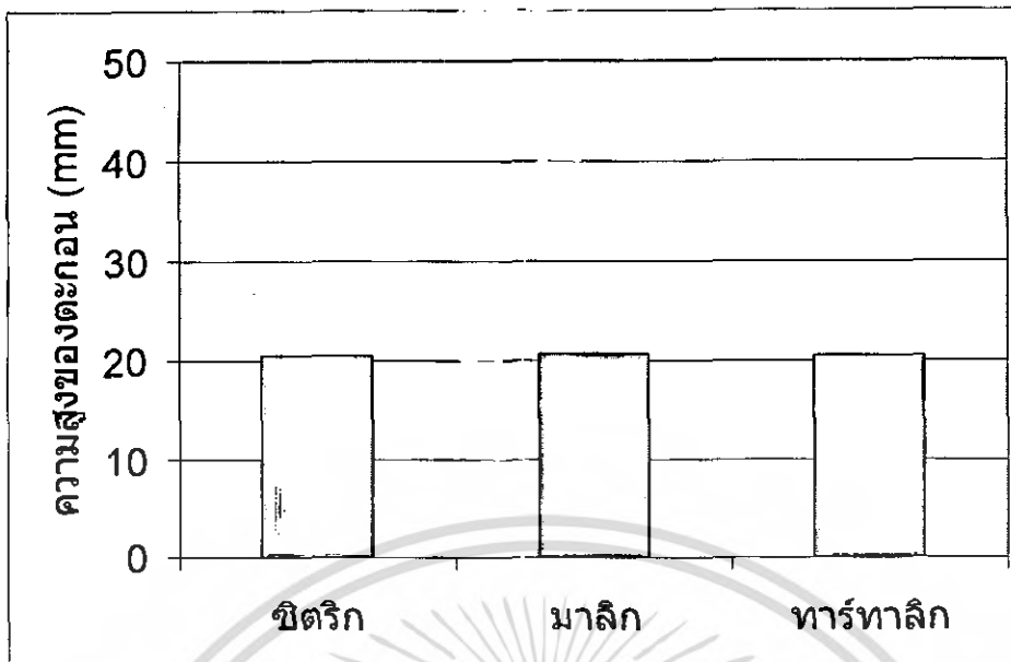
รูปที่ 4.2 แสดงปริมาณของตะกอนที่เกิดจากกรดต่างชนิดกัน
