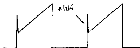
รูปที่ 5.3 แสดงลักษณะของสไปค์ที่ขอบขาขึ้นของกระแสไฟรมารี
