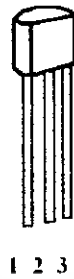
ภาพที่ 4.3 แสดงภาพเซนเซอร์วัดอุณหภูมิที่มี 3 pin
