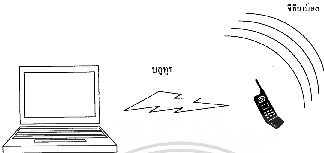
รูปที่ 3.7 แสดงการเชื่อมต่อจีพีอาร์เอส โดยเชื่อมต่อผ่านบลูทูธผ่านโทรศัพท์เคลื่อนที่
