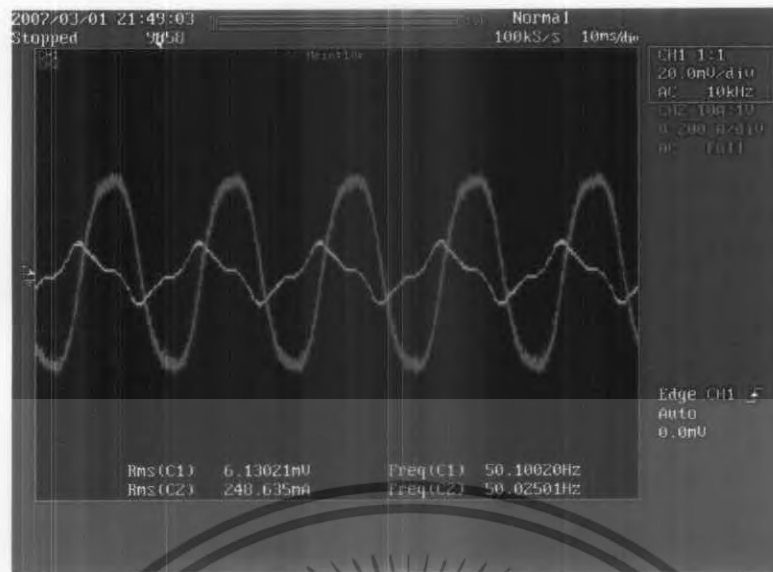
รูปที่ 4.5 แสดงตัวอย่างสัญญาณ V_{induce} ณ สาย Excite ในแกนเหล็ก Simulate วัดด้วย Search-Coil ขนาด 3x10x2 มม.
