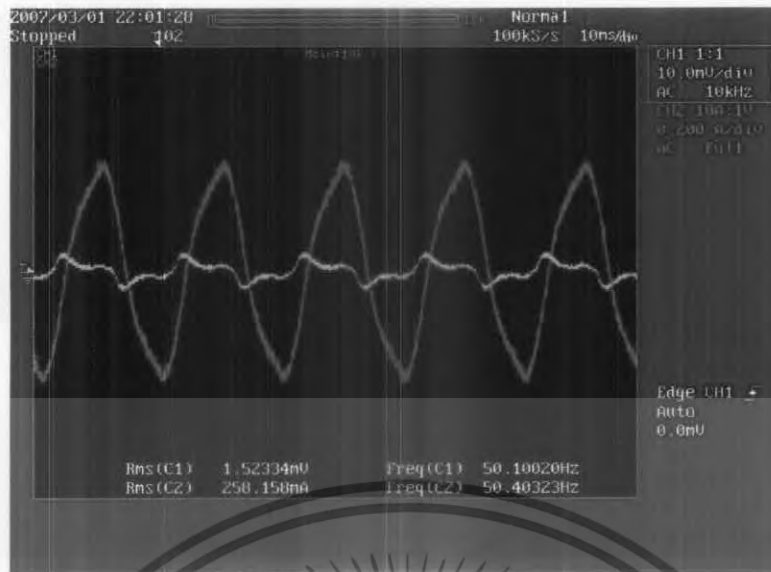
รูปที่ 4.13 แสดงตัวอย่างสัญญาณ V_{induce} ณ จุดปกติ ในแกนเหล็กที่ถูก Welding 50% ของความยาว Teeth วัดด้วย Search-Coil ขนาด 10x10x2 มม.
