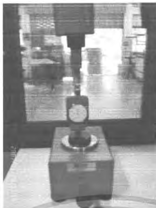
รูปที่ 3.4 เครื่องทดสอบความแข็งแบบ Durometer ชนิด Shore D
