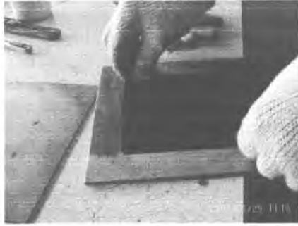
รูปที่ 3.6 การนำยางเข้าแม่พิมพ์เพื่อทำการอัด
