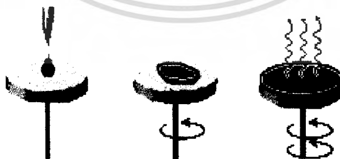
รูปที่ 2.4 กระบวนการเคลือบฟิล์มบาง
