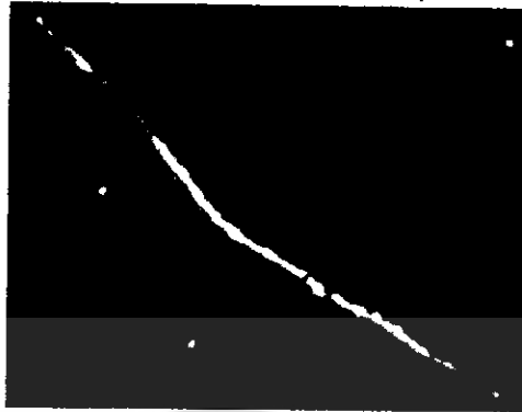
รูปที่ 2.20 ภาพจาก AFM ของเอ็นไอซ์มีกดูโคสออกซิเดสที่ตรึงอยู่บน SWNTs
