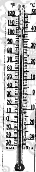
รูปที่ 2.1 แสดงภาพเทอร์โมมิเตอร์แบบ liquid-in-glass
