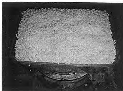
รูปที่ 3.2 พอลิस्टาไร์นโฟอร์ม : ก) พอลิस्टาไร์นโฟอร์มที่ยังไม่บดย่อย ข) พอลิस्टาไร์นโฟอร์มที่บดย่อยแล้ว
