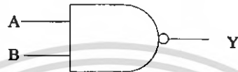
ภาพที่ 2.12 สัญลักษณ์ของเกตแนนด์ที่มีอินพุต 2 ตัว
