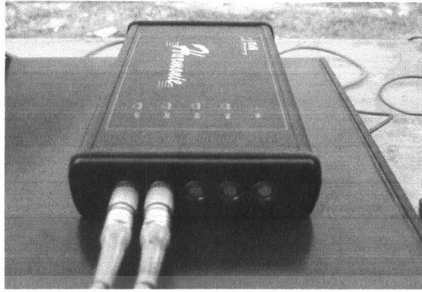
รูปที่ 3.11. ภาพแสดงการติดตั้งไมค์กับเครื่องวัดเสียงแบบวิเคราะห์ความถี่
