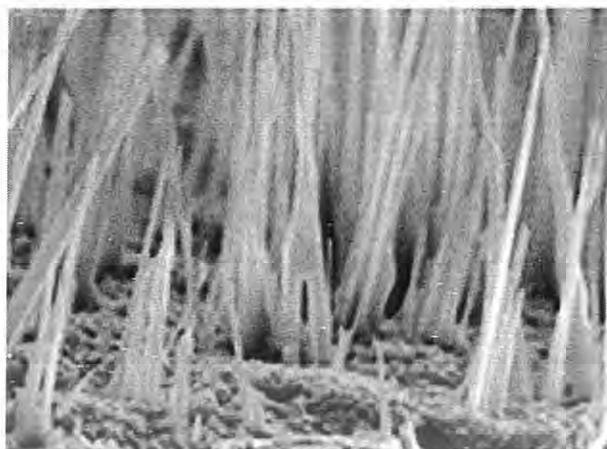
รูปที่ 2.14 เส้นลวดนาโนคอปเปอร์ออกไซด์ โดยเผาที่อุณหภูมิ 750 องศาเซลเซียส (Huang 2004)
