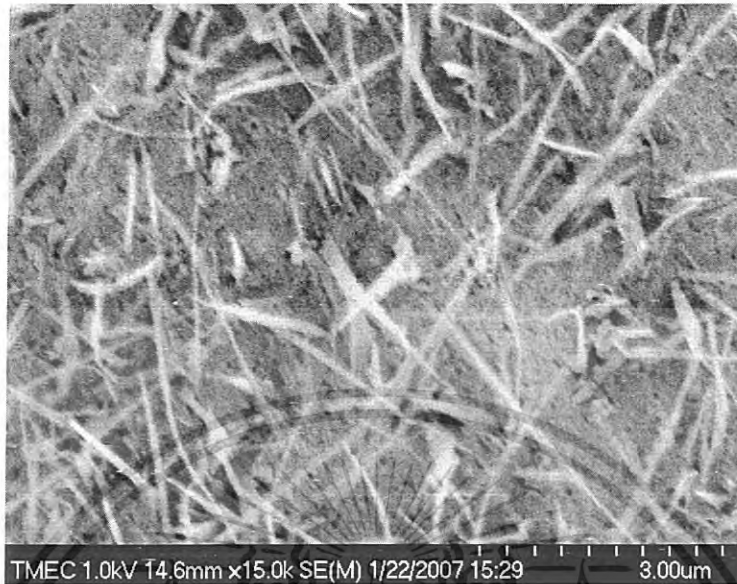
รูปที่ 4.10 เส้นลวดนาโนคอปเปอร์ออกไซด์ที่ได้จากการเผาในสภาวะออกซิเจน ที่อุณหภูมิ 550 องศาเซลเซียส 4 ชั่วโมง
