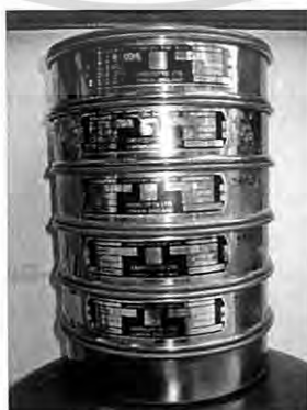
รูปที่ 3.3 เครื่องร่อนแยกขนาด 6 ระดับ (กรมป่าไม้)
