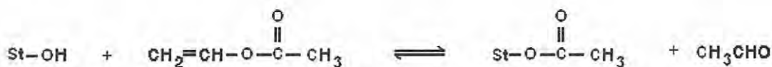
รูปที่ 2.14 ปฏิกิริยาระหว่างแป้งกับไวนิลอะซิเตต [15]
