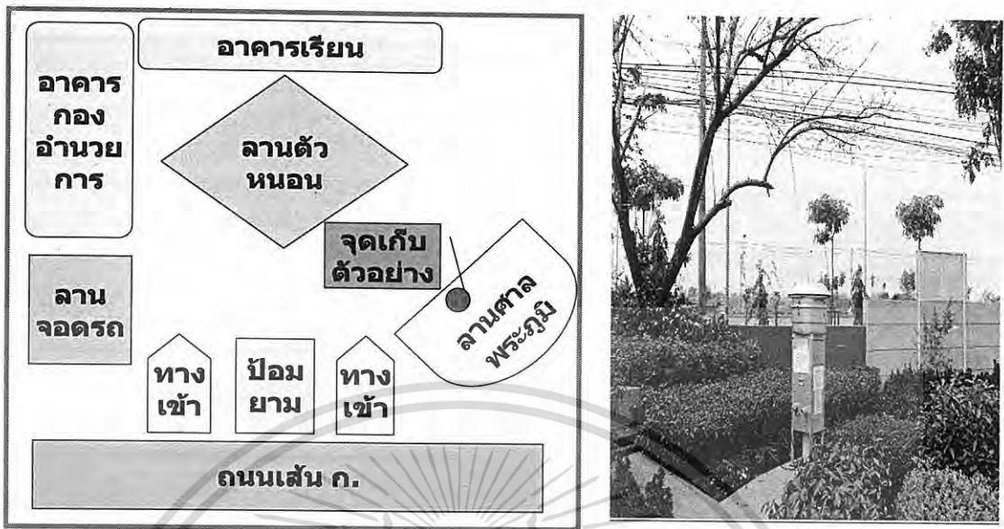
รูปที่ 3.3 แผนผังการติดตั้งเครื่องเก็บฝุ่นปริมาณมาก (High Volume Air Sampler) บริเวณเกริกวิทยาลัย
