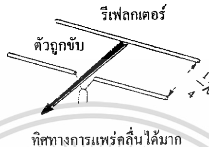
รูป 2.20 สายอากาศชนิดฮาล์ฟเวฟไดโพล (ใช้เป็นตัวถูกขับ)
