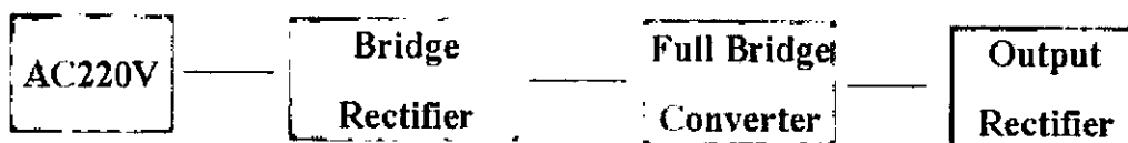
รูปที่ 3.5 แสดง BLOCK DIAGRAM ของวงจรส่วน CONVERTER
