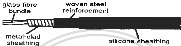
รูปที่ 2.30 โครงสร้างเส้นใยแก้วไฟเบอร์ออปติก
