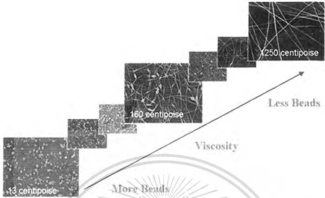
รูปที่ 2.2 ภาพที่ได้จากกล้องจุลทรรศน์คือเล็กตรอนแบบส่องกราด (SEM) ของพอลิเมอร์ที่ได้จากกระบวนการปั่นด้วยไฟฟ้าสถิตที่ได้จากสารละลายพอลิเมอร์ที่มีความเข้มข้นต่างกัน [16]
