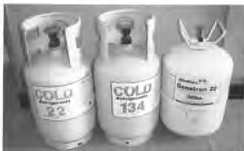
รูปที่ 3-20 แสดงถังสารทำความเย็น
