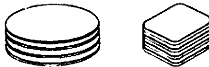
รูปที่ 2.6 แผ่นระบายความร้อนแบบกลมมีครีบริบระบายความร้อนหลายชั้น
