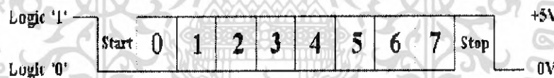
รูปที่ 2.8 แสดงรูปแบบข้อมูลอนุกรมแบบอะซิงโครนัส
