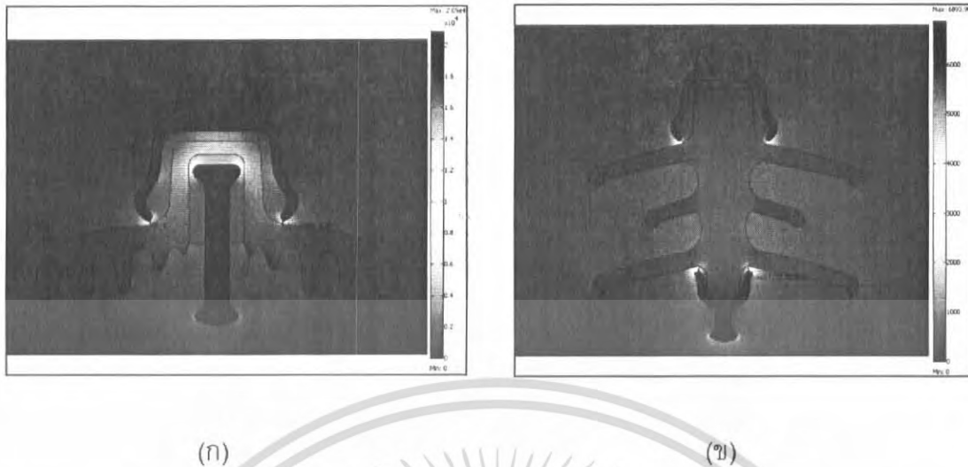
รูปที่ 5.1 วิเคราะห์ค่าความเครียดสนามไฟฟ้าของลูกถ้วยแขวน (ก) ลูกถ้วยแขวนต้นแบบ (ข) ลูกถ้วยแขวนที่ออกแบบ
