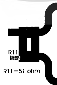
รูปแผ่นลายทองแดงและการวางอุปกรณ์ของวงจรไฮบริดจี้คัปเปิลอร์ 90°
