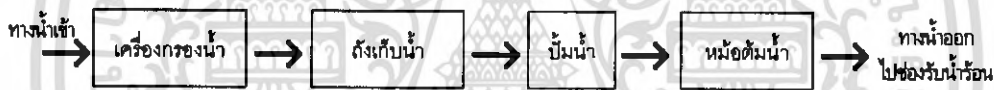
รูปที่ 3.15 แสดงบล็อกไดอะแกรมของภาคจ่ายน้ำ
