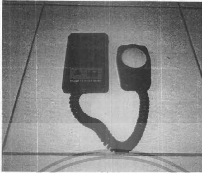
ภาพที่ 3.23 เครื่องมือวัดค่าแสงลักซ์มิเตอร์ (Lux meter)
