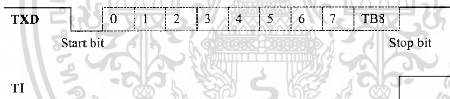
รูปที่ 2.20 แสดง Timing Diagram การส่งข้อมูลโหมด 2
