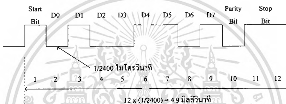
รูปที่ 2.12 แผนภาพสัญญาณเวลาของข้อมูลแบบอนุกรมจำนวน 8 บิต พร้อมด้วยบิตเริ่มต้นบิตพาริตี และ บิตสุดท้าย
