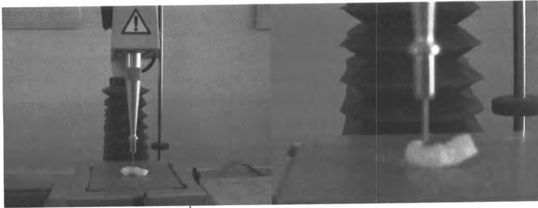
รูปที่ ๒.๒๗ เครื่องวัดTexture โดยใช้หัววัดแบบProbe P/2
