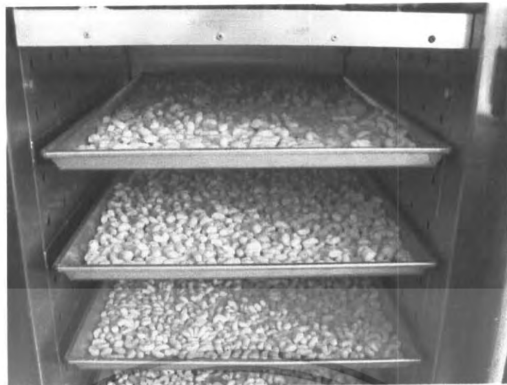
รูปที่ ง.19 นำเอ็กซ์ทรูเดทที่ได้ไปอบแห้งด้วย Tray Dryer 80°C ,15นาที
