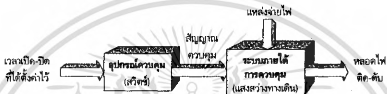
รูปที่ 2.9 ผังสัญญาณแสดงหลักการทำงานของระบบควบคุมวงเปิด
