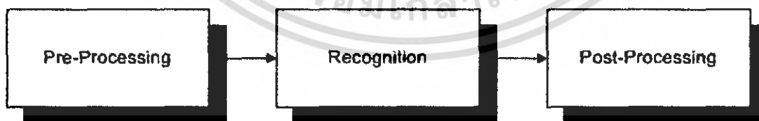
รูปที่ 2.29 โครงสร้างทั่วไปของระบบโอซีอาร์
