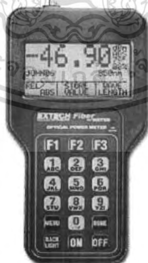
ภาพที่ 7.4 Power meter
