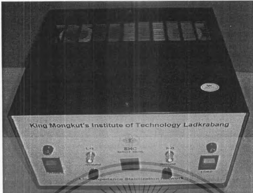
รูปที่ 3.55 ภาพถ่ายตัวถังโครงข่ายรักษาเสถียรภาพอิมพีแดนซ์เมื่อประกอบเสร็จ
