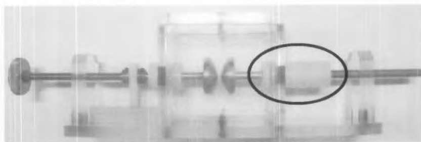
รูปที่ 3.4 ฉนวนไฟฟ้าแรงสูง
