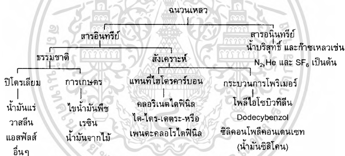
รูปที่ 2.1 ไดอะแกรมของฉนวนเหลว [1]
