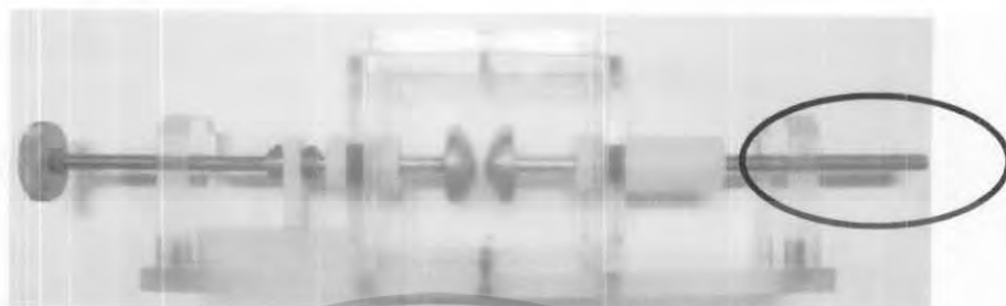
รูปที่ 3.5 แกนตัวนำไฟฟ้าทางด้านไฟฟ้าแรงสูง
