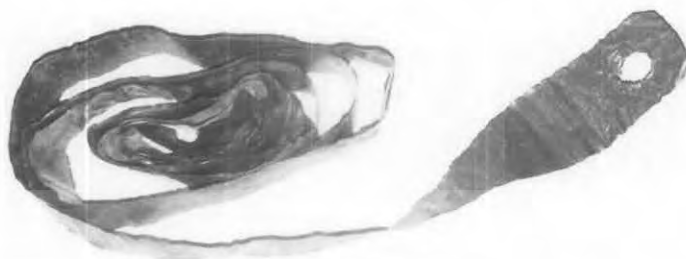
รูปที่ 4.52 สายนำแรงสูง
