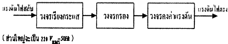
รูปที่ 2.25 แผนภาพบล็อกของแหล่งจ่ายไฟตรง
