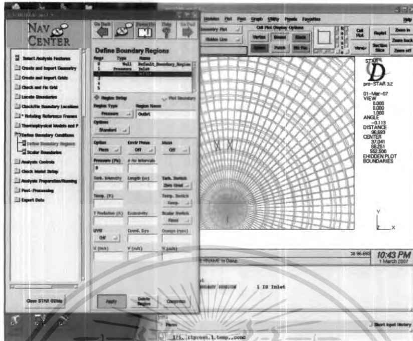
รูปที่ 6-76 การใช้ Star-CD ในการจำลองผลขั้นตอนที่ 21 จากรูปที่ 6-76 ทำการกำหนดสถานะของ Boundary โดยเข้าไปคำสั่งที่ Define Boundary Conditions → Define Boundary Regions
