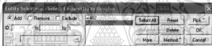
รูปที่ 6-45 การ Generate Mesh โดยใช้โปรแกรม NASTRAN ขั้นตอนที่ 17 เลือกที่บริเวณ Element แล้วเลือก Select All แล้วกด OK
