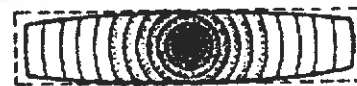
แสดงการหดตัวของแผ่นทำให้เกิดการโค้งงอ รูปร่างที่โค้งงอจะตรงกันข้ามกับส่วนของวงปี
