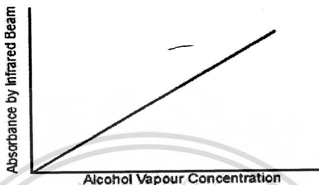
รูปที่ 2.5 แสดงความสัมพันธ์ของความเข้มข้นของ แอลกอฮอล์กับการดูดกลืนรังสีอินฟราเรด (Beer's Law)
