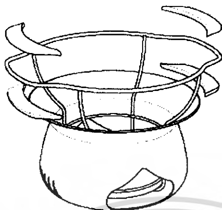
ภาพที่ 129 ทำหูจับด้วยวัสดุที่เป็นฉนวน ประกบตรงที่จับที่เป็นสแตนเลส
