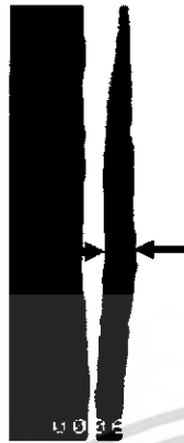
รูปที่ 4.8 แสดงภาพถ่ายด้านตัดขวางของกระจกสไลด์ที่มีฟิล์มบางเคลือบอยู่ เพื่อวัดความหนาของฟิล์มที่เคลือบได้ซึ่งมีค่าประมาณ 100 นาโนเมตร
