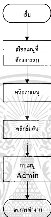
รูปที่ 3.14 แผนผังแสดงขั้นตอนการลบข้อมูลเมนูของ Admin
