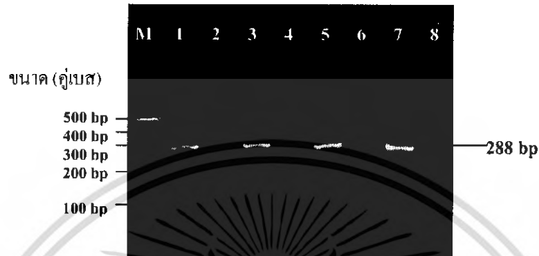
รูปที่ 4.2 ผลิตภัณฑ์ PCR จากปฏิกิริยาลูกโซ่พอลิเมอไรเซชัน 16S rRNA จากดีเอ็นเอต้นแบบต่างๆ
