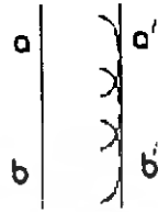
รูปที่ 2.6 แสดงหน้าคลื่น โดย ab เป็นหน้าคลื่นเดิม, a'b' เป็นหน้าคลื่นใหม่
