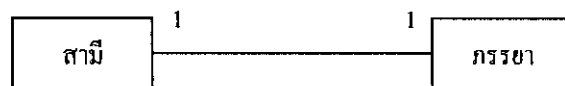
รูปที่ 2.14 รูปภาพแสดงตัวอย่างความสัมพันธ์เอนทิตีแบบ one to one
